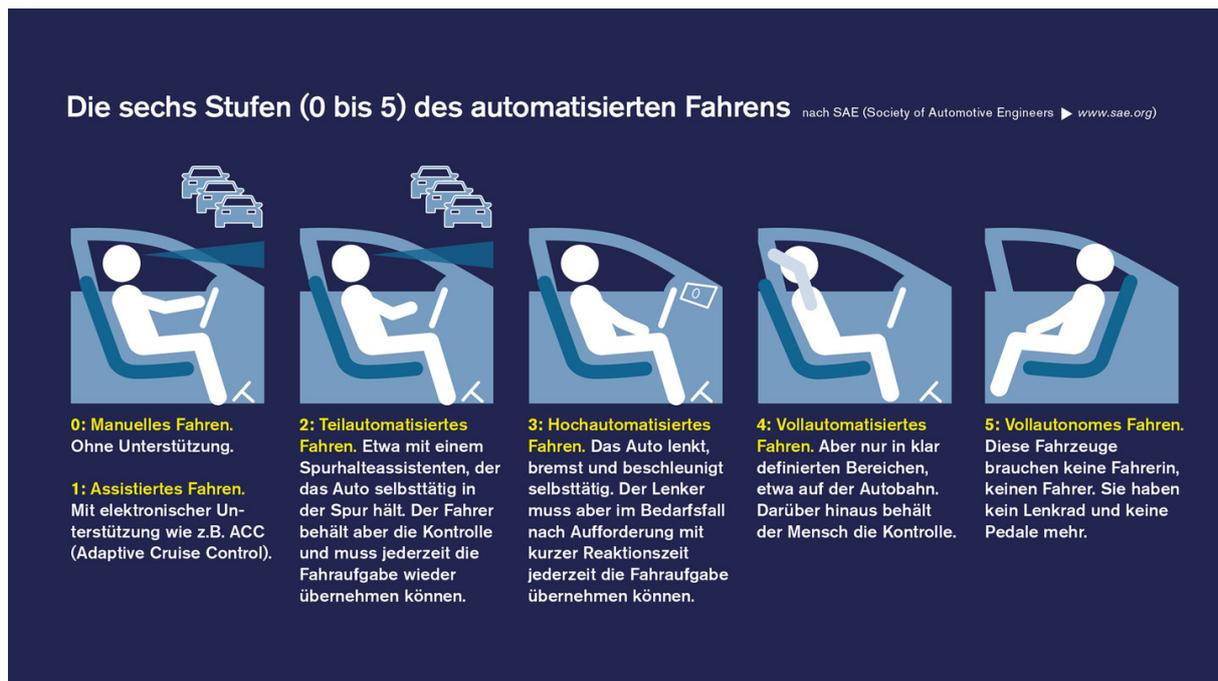
Abbildung 1: Klassifizierung autonom fahrender Autos (Quelle: [www.oeamtc.at](http://www.oeamtc.at))
