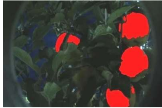
Abbildung 3: Segmentierung von Äpfeln in einem Bild. Die erkannten Äpfel wurden rot eingefärbt. Quelle: [17]
