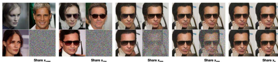
Abbildung 4: Reverse Diffusion auf dem CelebA-HQ Datensatz beginnend bei verschieden stark verrauschten Startbildern [12].
